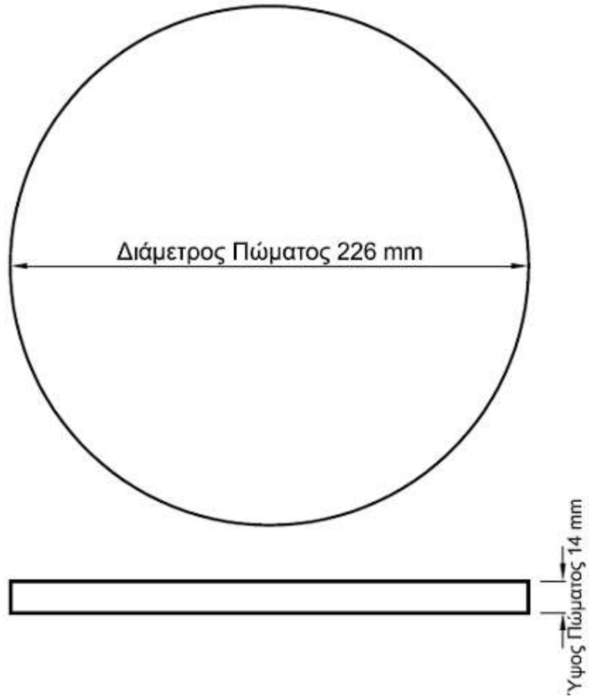
Σχέδιο 2. Διαστάσεις πλαστικού πώματος
